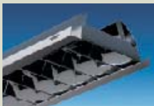
Zrcalni raster BAP 60/DARK Cat.2 L ≤ 200cd/m 2 za kot izsevanja ≥ 60°
