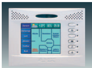
Zaslon osjetljiv na dodir 4" (4-inčni zaslon/Touch screen) za upravljač DALI Comfort s integriranim mikrofonom i zvučnikom
