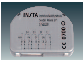
Radijski višefunkcijski odašiljač Mini 4 kanala, za ugradnju u kutiju prekidača
