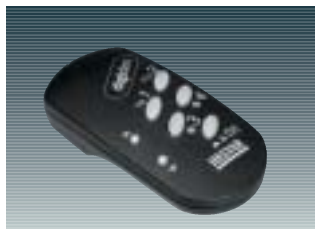
Daljinski upravljalnik DALI Digidim za upravljanje 4 skupin, VKLOP/IZKLOP, svetleje/temneje, in za zagon enostavnejših aplikacij
